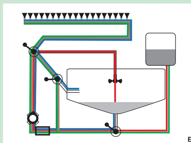
**1<sup>re</sup> étape du rinçage** Le rinçage du pulvérisateur est effectué à l'aide des buses de rinçage intérieures avec  $\frac{1}{3}$  du volume d'eau claire provenant du réservoir d'eau claire.
